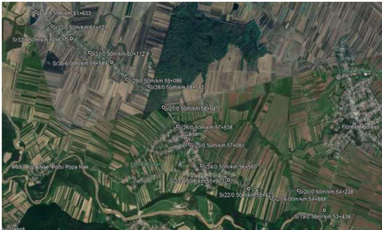
Figura 2 - amplasamente sondaje geotehnice Sr19-Sr34, pe tronson 2, km 53+438 - km 61+932
