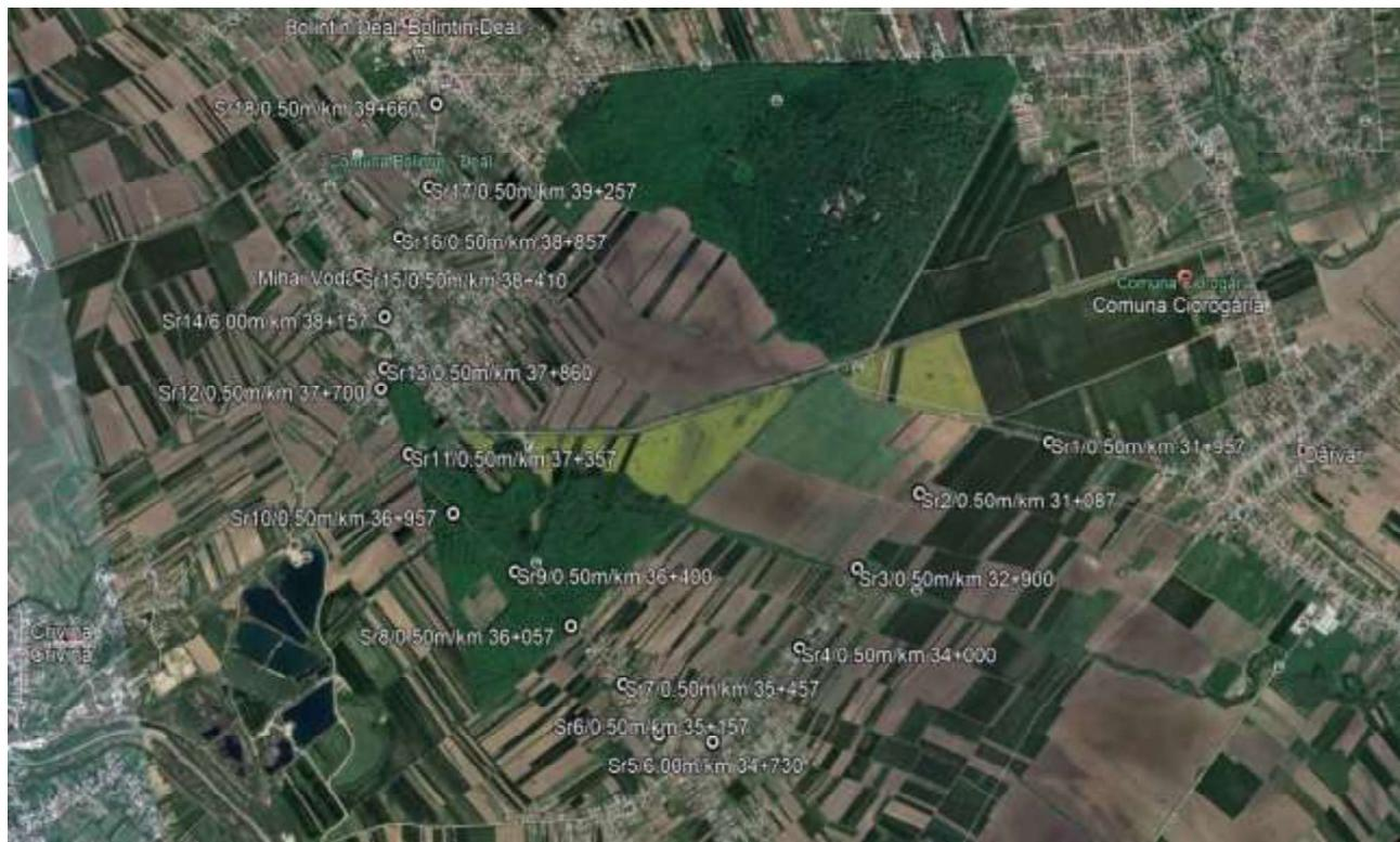
Figura 1- amplasamente sondaje geotehnice Sr1-Sr18, pe tronson 1, km 31+900 - km 39+820
